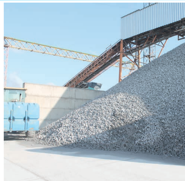
Отдельный вид продукции, изготавливаемый на дробильном комплексе предприятия – шлаковый щебень фракций от 5 до 70 миллиметров.
